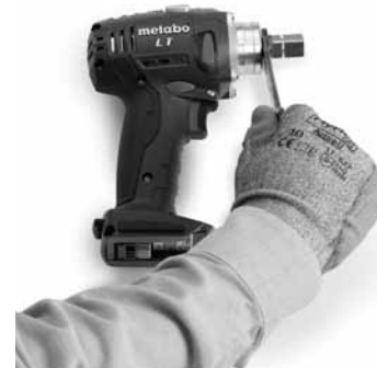
Fig. 34 : Dépose de l'écrou d'entraînement
