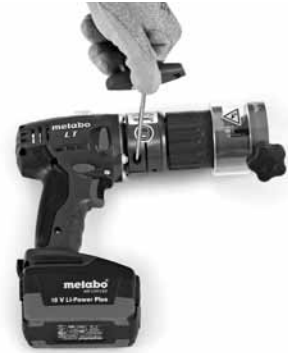
Fig. 32 : Desserrage de la vis de blocage
