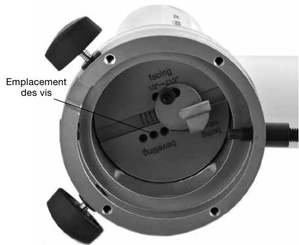
Fig. 14 : Installation du porte-outil, série TF40
