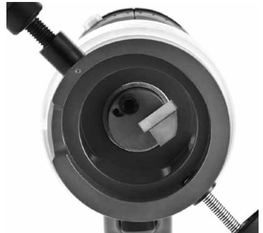
Fig. 13 : Installation du porte-outil, séries TF16 et TF24
