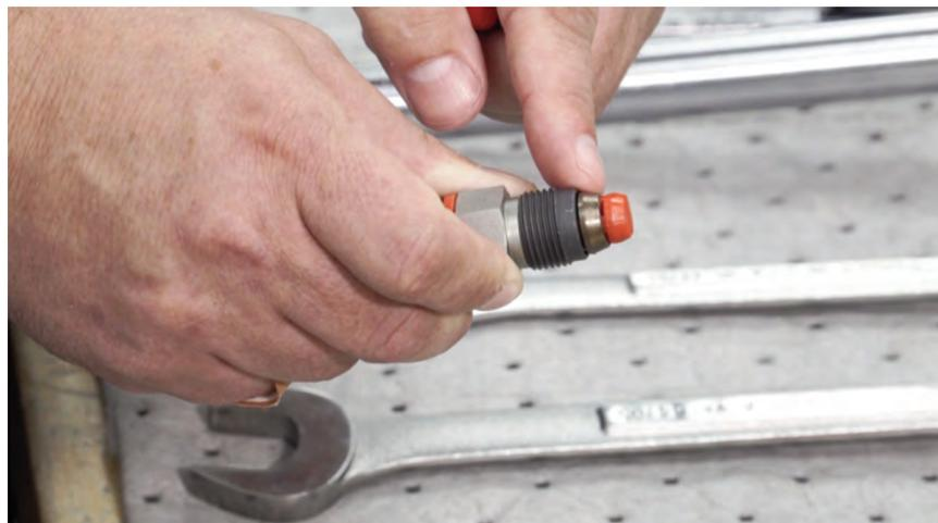
Figura 2. Para facilitar el montaje, los racores serie FK Swagelok incluyen una tuerca macho, dos férulas y un eje de plástico desmontable que encaja en el puerto hembra del cuerpo del racor. Imagen © Swagelok Company 2020
