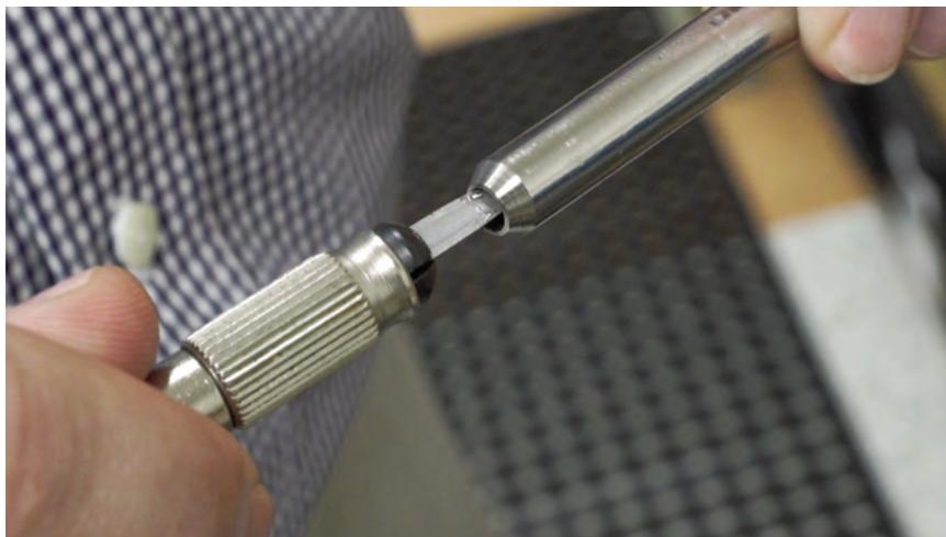
Figura 1. Los accesorios con cono y rosca exigen que los operarios mecanicen manualmente una superficie de cierre cónica (mostrada) y la rosca en ambos extremos del tubo antes de hacer las conexiones. Imagen © Swagelok Company 2020
