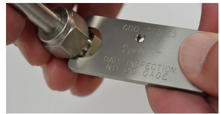
Si la galga no entra en el espacio, el racor está suficientemente apretado
