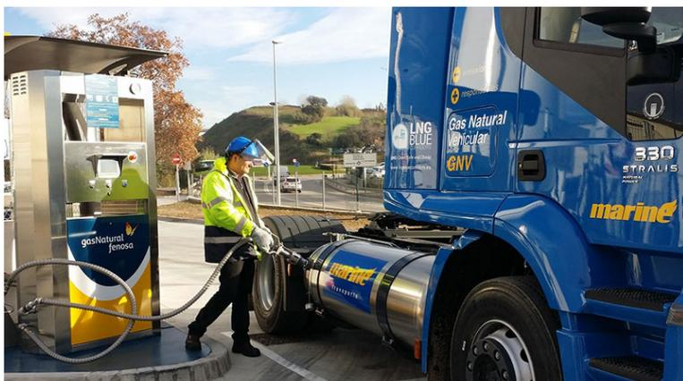
No obstante, este combustible ofrece ventajas adicionales: los motores de gas natural reducen hasta en un 50% la emisión sonora y las vibraciones respecto a un motor que use gasoil como combustible, alargando la vida útil del motor; asimismo los usuarios de este tipo de vehículos pueden disfrutar de diferentes subvenciones tanto de impuestos de circulación, como de aparcamientos y peajes de autopistas, dependiendo de los distintos municipios o comunidades por las que circulemos.
