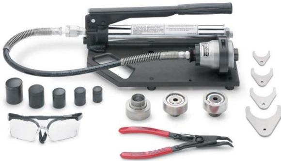
Esta herramienta permite deformar las férulas en el tubo antes de realizar la instalación final del racor. Esto reduce la fuerza a aplicar, por lo que facilita el montaje. Con la galga “no pasa” específica de la herramienta, se puede verificar que el racor está bien instalado. Tamaños de matriz disponibles de forma inmediata: 1”, 1 ¼”, 1 ½” y 2”, 25mm, 28mm, 30 mm, 32 mm, y 38mm.
