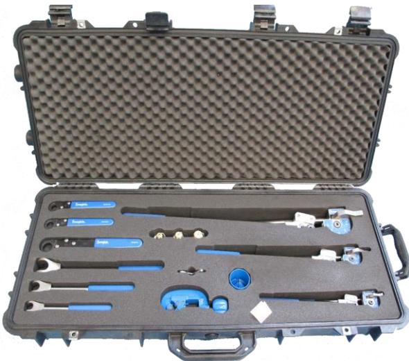
Maleta de herramientas en la que hemos reunido un conjunto de herramientas manuales Swagelok® diseñadas específicamente para fabricar sistemas de tubos con los tres tamaños de tubo más comunes: 1/4, 3/8 y 1/2 pulgada de diámetro exterior (OD). Todas las herramientas se almacenan de forma segura en una maleta resistente al agua y con cierre. Cuenta con ruedas de goma para facilitar su uso y transporte.
