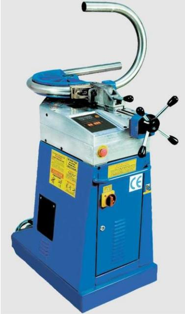
La dobladora de tubo tiene una construcción robusta que permite doblar de forma cómoda tubos de hasta 1 ¼ " o 30 mm a ángulos entre 1 a 180°.
