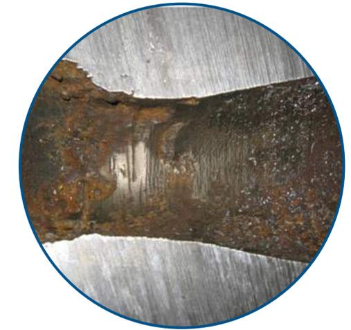
Agrietamiento por Gases Sulfurosos
