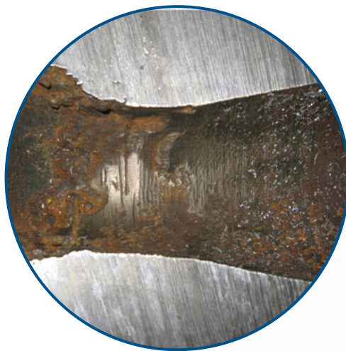
Corrosión bajo Tensión de Gases Sulfurosos o Sulfuros
