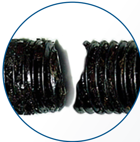
Debilitamiento por Hidrógeno
