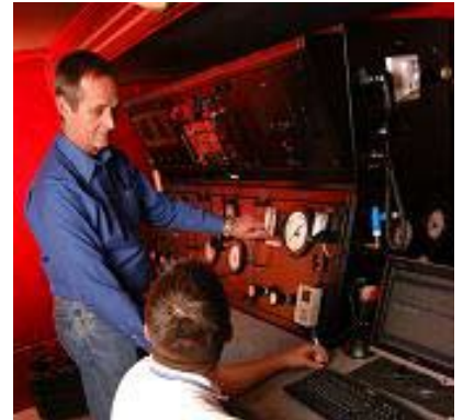
1/4インチ・ラインは、分析器システムに接続され、チャンバーの奥行と一酸化炭素レベルを感知して、チャンバー・アテンダントによってモニターされます。
