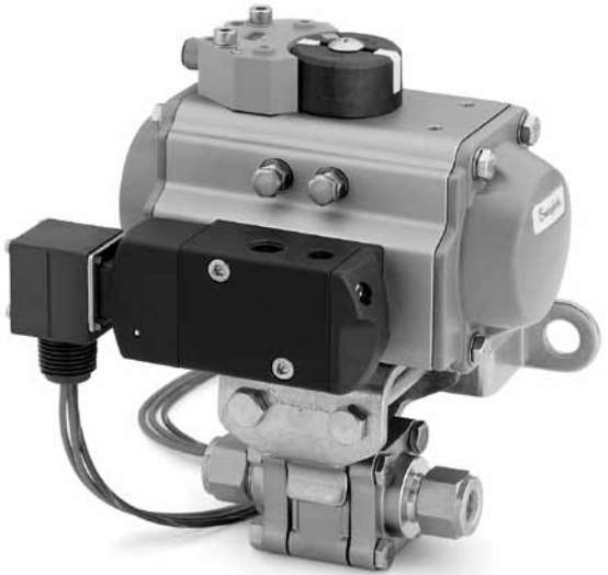
带执行机构, 电磁阀和接近 传感器的世伟洛克 63 系 列阀。
